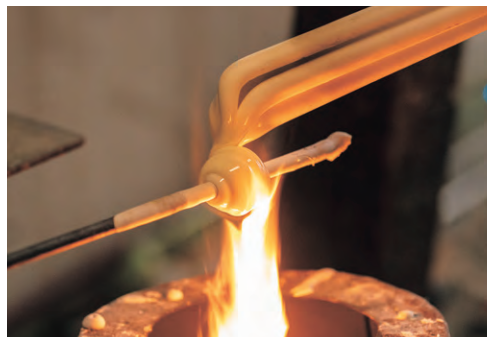
火の様子をうかがいながら、熱したガラスを巻き付けていく
