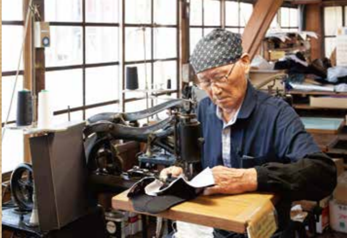
右手でミシンを調整しながら、指先のふくらみを立体的に縫う「爪縫い」
