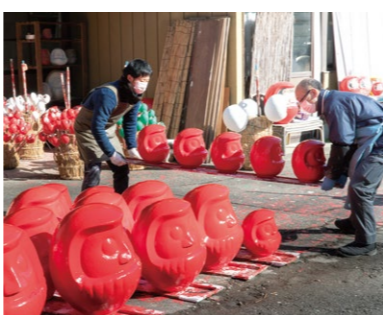
上州のからっ風が乾燥工程に欠かせない
