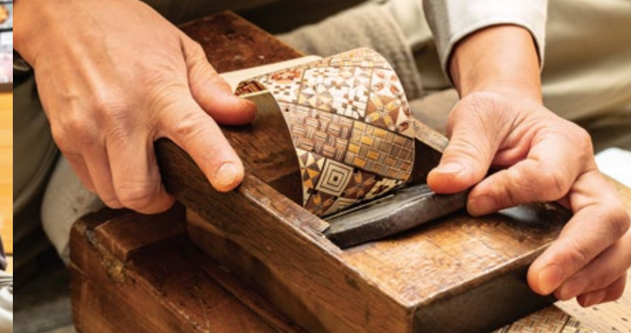
種板は0.15mmの薄さで削られる
