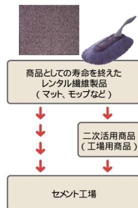
再生できない商品は、セメント工場の燃料として利用。さらに残った灰までセメント原料にすることで、100%再資源化
