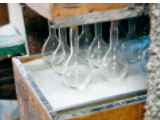
すき通ったガラスの型に溶かしたゴムをつける。まずは白。乾くと透明になる。
