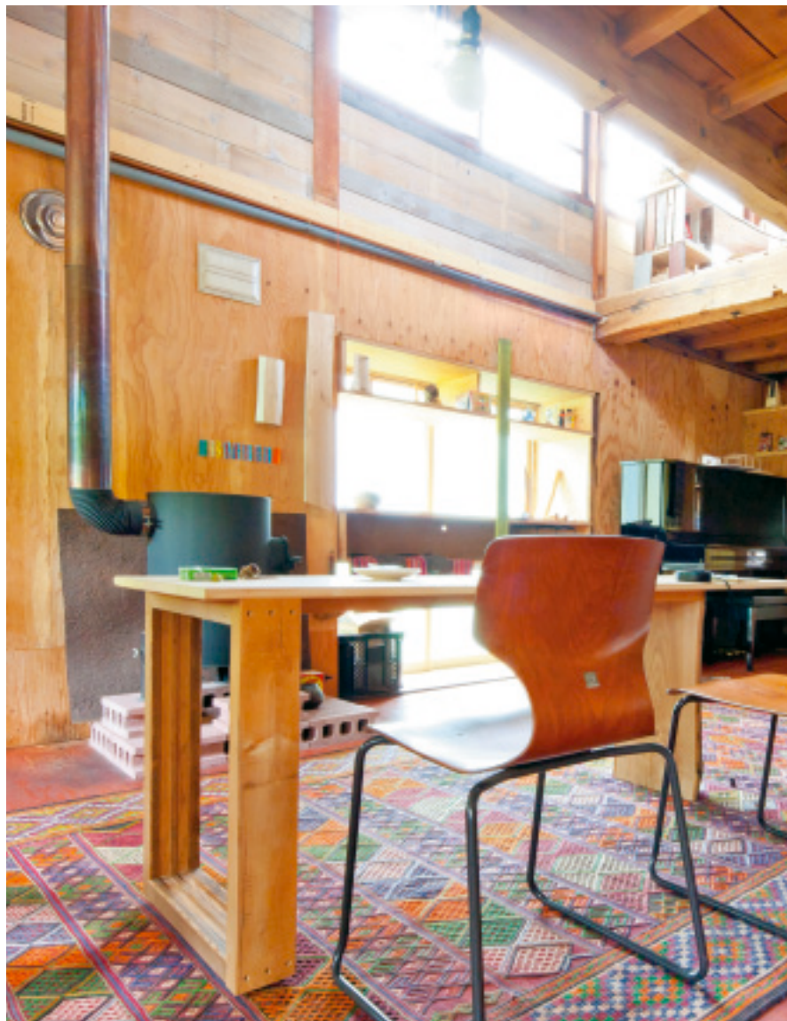
薪を太いまま放り込める大きなストーブ。まっすぐな煙突なのでススが出ない。
